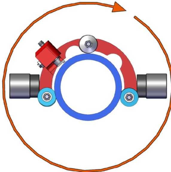
2. Observer la conformité du copeau. Si la largeur du copeau est égale à maximum 2/3 de la largeur de la lame, continuez à tourner le racleur mécanique autour du tube jusqu'à la fin du grattage.
